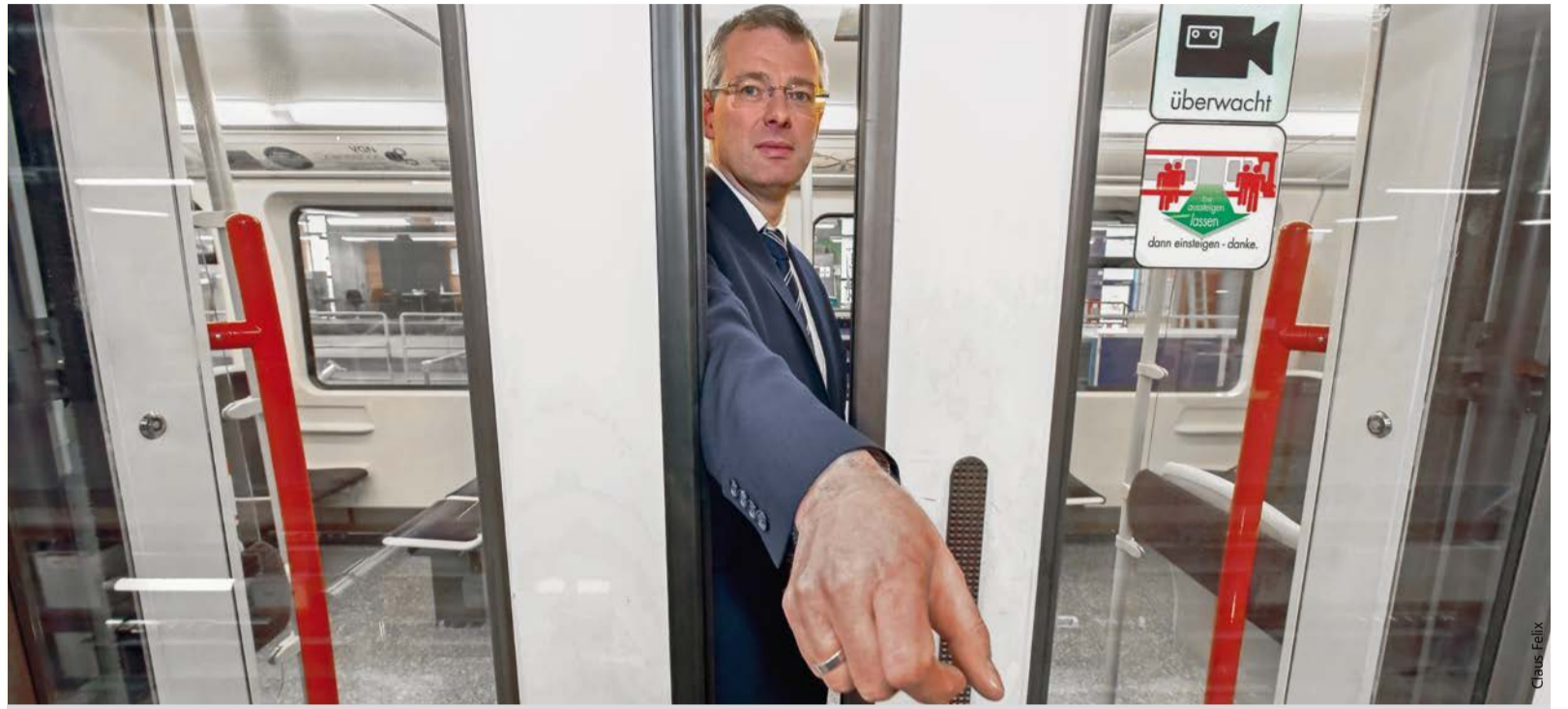
Thomas Luber demonstriert es: Werden Gegenstände oder Körperteile eingeklemmt, öffnen sich die Türen automatisch, der Zug fährt nicht ab.
