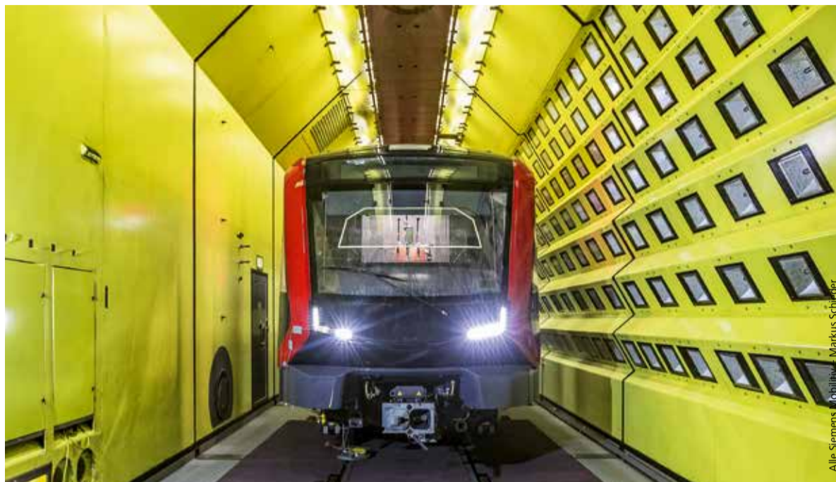
Der G1 im längsten Klima-Wind-Kanal der Welt. Er muss zeigen, dass er bei Eis und Hitze zuverlässig ist.
