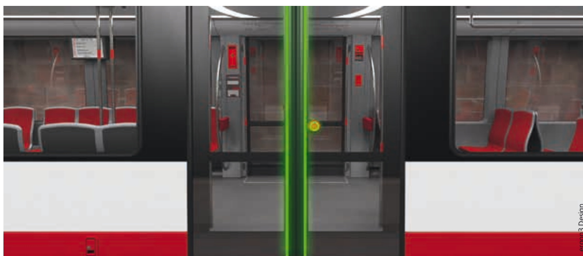
Die neuen G1-Züge signalisieren optisch, wann Fahrgäste zusteigen können bzw. die Türen geschlossen sind.
